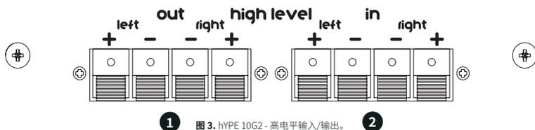
1 用于左右高电平输出端(输出)的正负极连接端子
